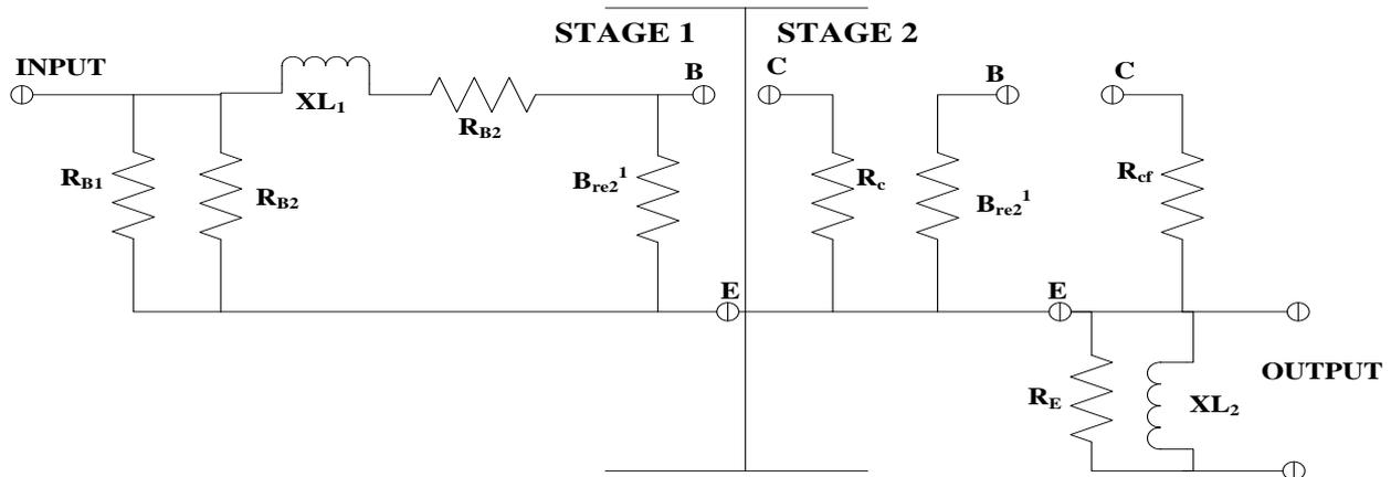
Fig 2: AC EQUIVALENT CIRCUIT FOR LNA DESIGN
