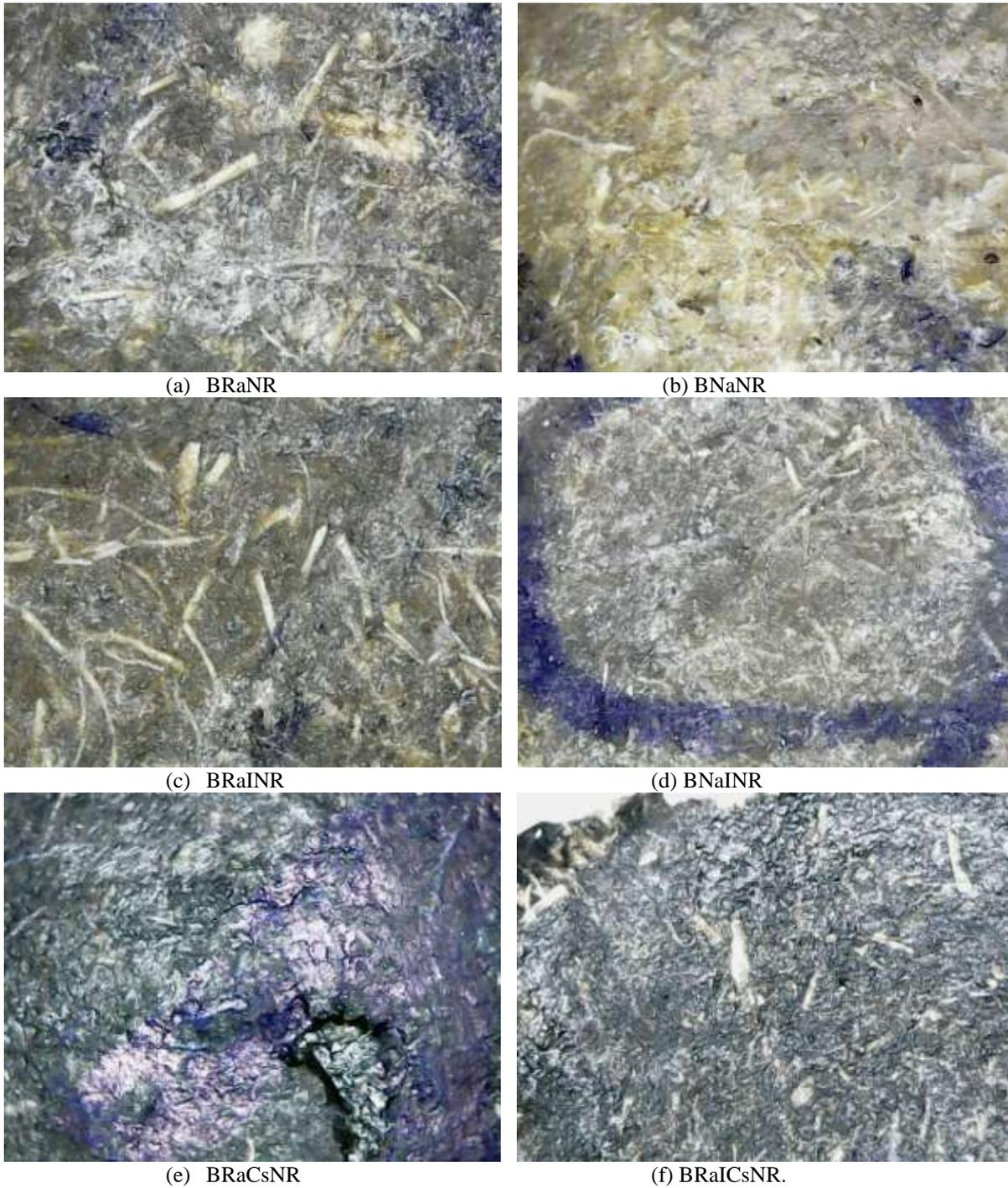
**Fig.5. Specimen Surfaces after Compression Test (a) BRaNR, (b) BNaNR, (c) BRaINR, (d) BNaINR, (e) BRaCsNR, (f) BRaICsNR.**
