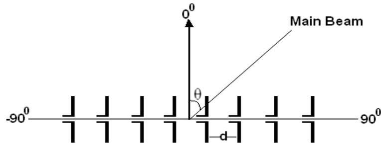
Fig. 3:Uniform linear antenna array
